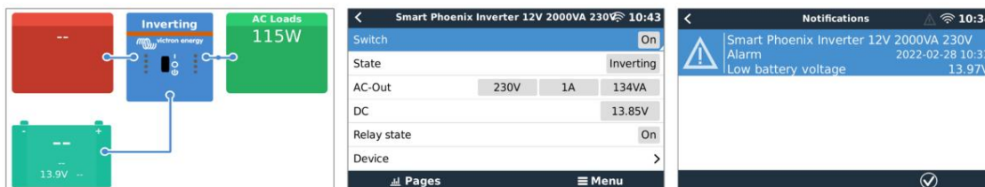
Příklad obrazovek GX zleva doprava: obrazovka systému, obrazovka zařízení střídače a zpráva alarmu.
